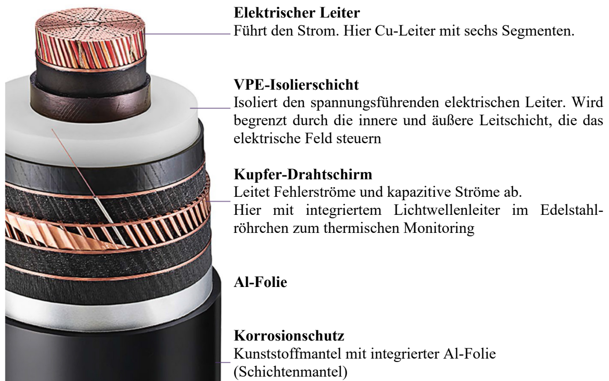
Abb. 3.1: VPE-isoliertes Einleiterkabel (Quelle: Nexans)
